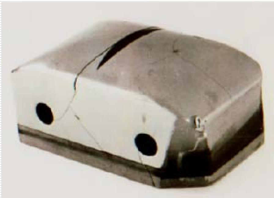
DBTT以下の温度からプラズマにさらし、クラックの入ったWブロック (TEXTORでの実験)
